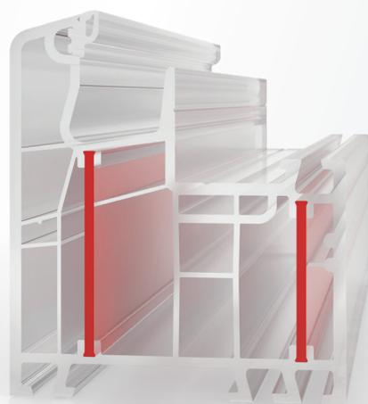
Stahl auf ein Minimum reduzieren oder gar ganz weglassen - In Kooperation mit der BASF wurde ein spezieller glasfaserverstärkter Kunststoff entwickelt, der im Inneren der Profile für die nötige Stabilität sorgt und eine zusätzliche Verstärkung aus Stahl überflüssig macht. Mit powerdur, der direkt ab Werk in das Profil eingebracht wird, werden wesentlich bessere Dämmwerte erzielt.
